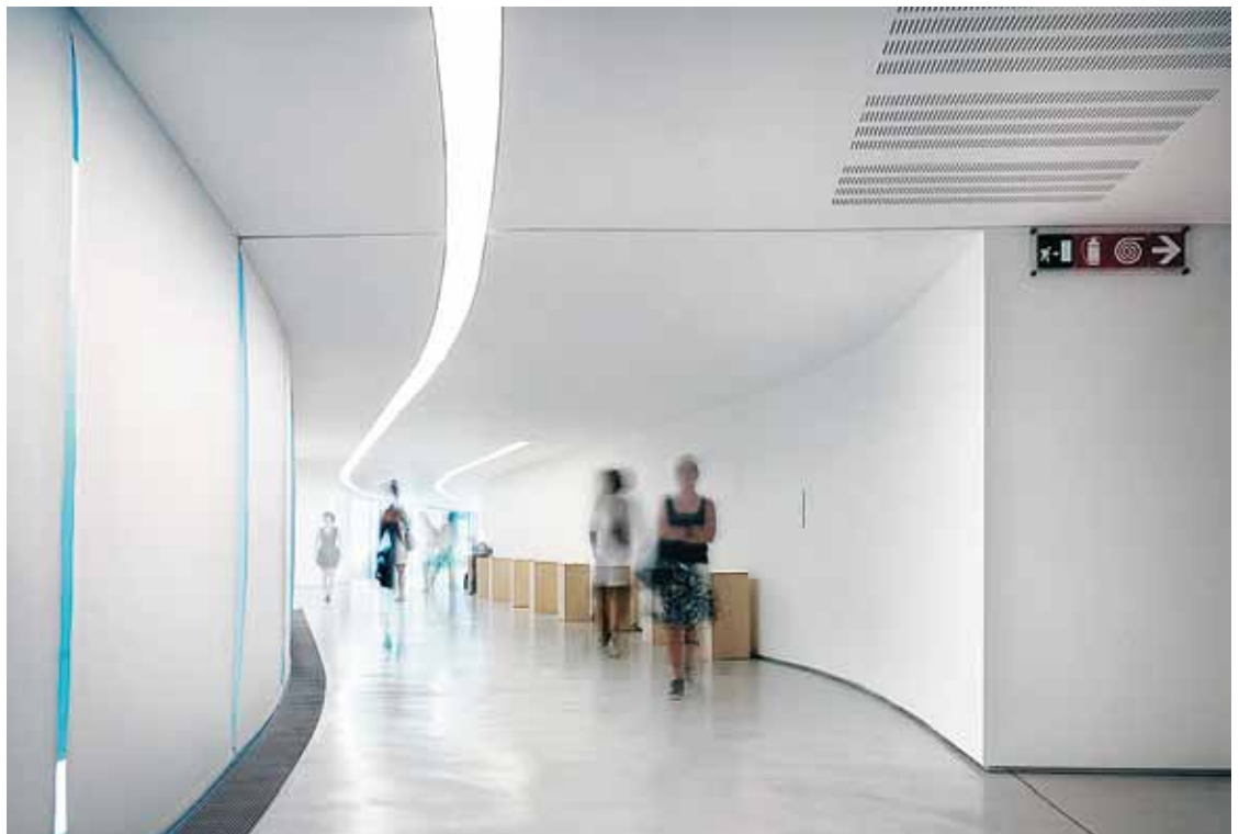
B5 | Die Beleuchtung ist als durchgehendes Lichtband in die Decke integriert und dient auch zur gleichmäßigen Ausleuchtung der Wände.
